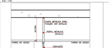
Detalhe Fixação Conjunto de Vidro e Laje - Corte
