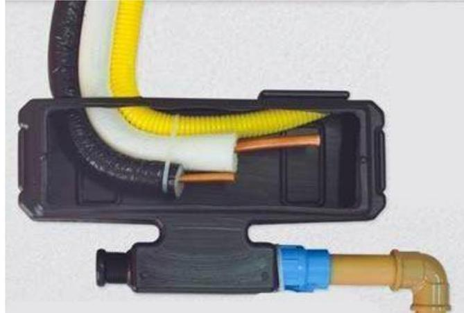
Nestas caixas de passagem deverão ser instaladas as conexões para ligação de drenagem de condensado produzido pela serpentina das unidades evaporadoras. A caixa deve garantir o desnível favorável da saída do dreno eliminando os riscos de infiltração.
