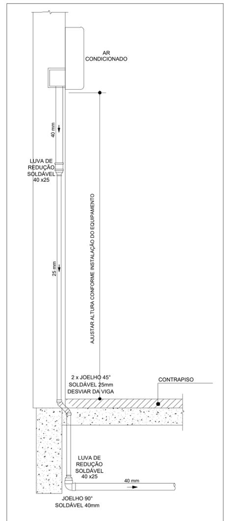
CORTE ESQUEMÁTICO - DRENO DO AR CONDICIONADO
