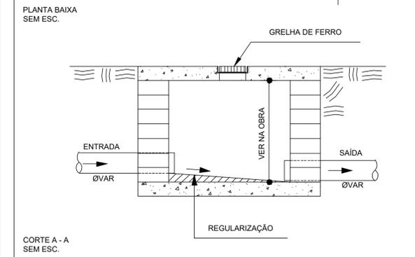
DETALHE CAIXA DE CAPTAÇÃO PLUVIAL
